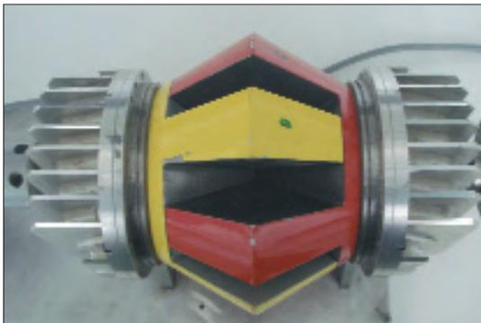
**Bild 7.** Blick in das Innere einer Schukey-Maschine. Zu sehen sind die beiden Flügelkreuze (rot und gelb). An den Spitzen links und rechts befinden sich die beiden Getriebe. Jedes Getriebe treibt jeweils einen Rotor an
